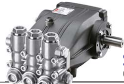
SERIE NHD G1 CULATA DE LATÓN (251x164x238mm | 8Kg | eje Ø25,4mm | SAE 10W40)
